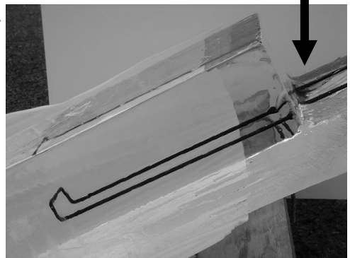
補助具に沿って隙間が出来、水が流れる
